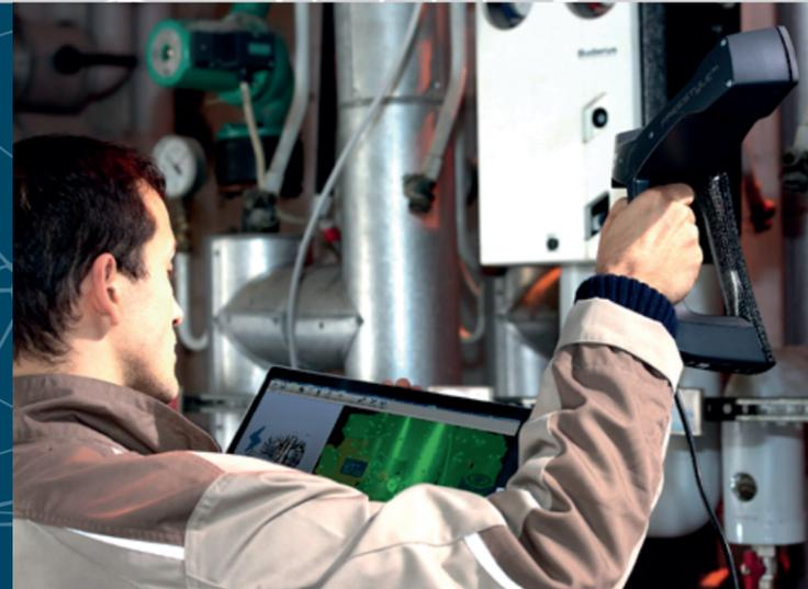
La tecnica viene svolta attraverso strumenti di altissima precisione: il Laser Scanner 3D Automatico con capacità fino a 130 mt e Laser Scanner 3D Manuale per i luoghi più angusti e inarrivabili. La funzione formazione immagine HDR e le fotografie ad alta risoluzione offrono risultati di scansione realistici e straordinariamente fedeli ai dettagli.
