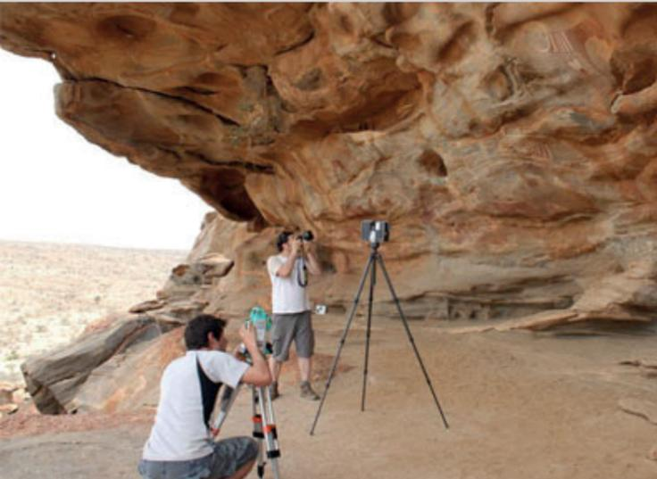
Il Laser Scanner 3D è uno strumento di alta tecnologia le cui peculiarità sono di rilevare oggetti di piccole o grandi dimensioni in tempi brevissimi ed in modo automatico. Grazie alla sua velocità di acquisizione e precisione nelle misure, il rilievo laser scanner rappresenta indubbiamente il metodo più efficiente nella generazione di documentazione 3D restituendo nuvole di punti dettagliate che consentono la modellazione cad dell'oggetto rilevato in maniera precisa e realistica.
